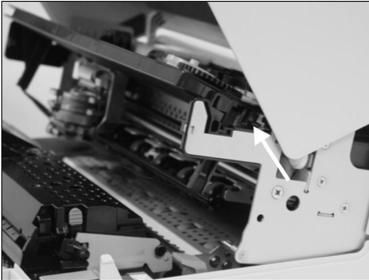
Setzen Sie die neue Farbbandkassette ein, indem Sie sie zuerst in die hinteren Öffnungen der Halterung einlegen.
