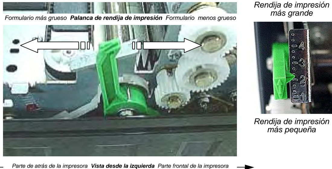
Ajuste de la palanca para la rendija de impresión
